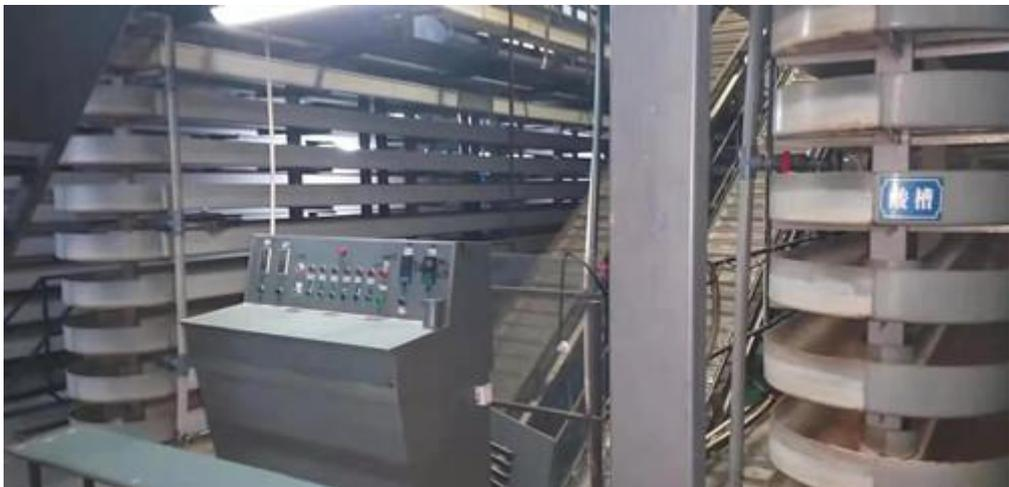
橘子罐头的核心科技---改造升级的酸碱流槽已初见雏形。
